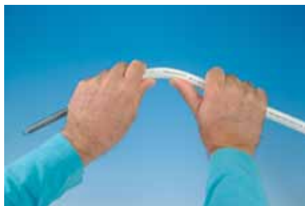
Гибка с помощью внутренней гибочной пружины
